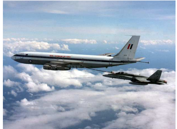
Boeing-707 utilisé en ravitaillement (KC 135) ⚡
